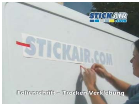
Ihre Schrift ist jetzt richtig platziert, Sie können nun die Klebestreifen entfernen
