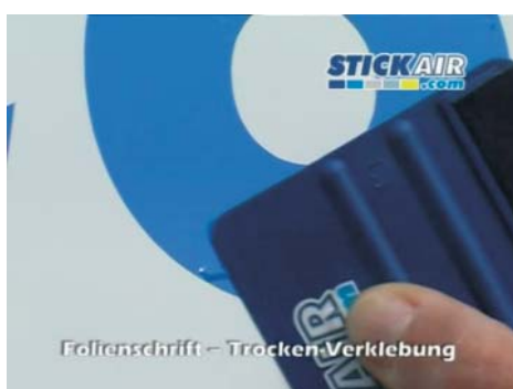
Sollte sich zwischen dem Vinyl und der beklebten Fläche eine Luftblase gebildet haben, streichen Sie sie vorsichtig mit dem Rakel aus. Befindet sich die Blase zu weit vom Rand entfernt, durchstechen Sie sie mit einer Nadel.
